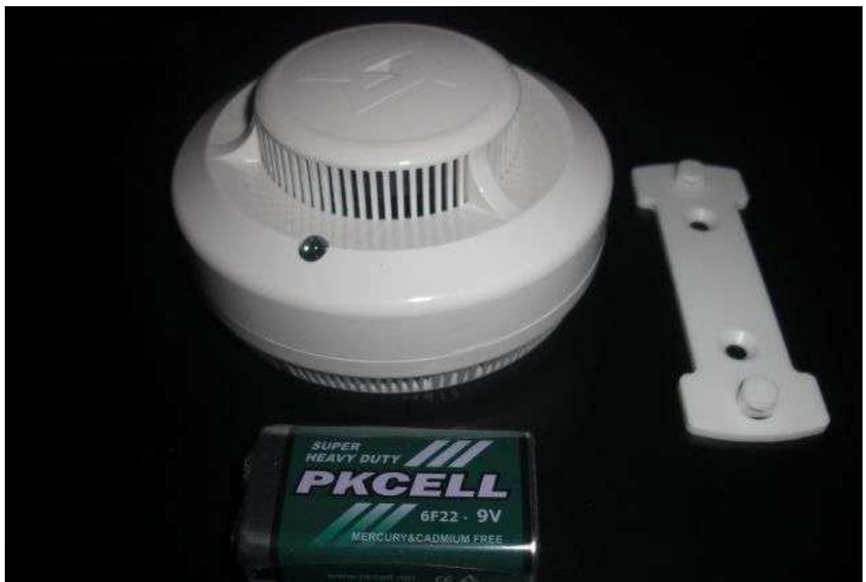
Принцип действия оптико-электронного извещателя основывается на использовании оптического эффекта, при помощи которого извещатель определяет дым с помощью инфракрасного излучения. Расположенные в камере извещателя светодиоды испускают инфракрасные лучи. Когда внутрь камеры попадают частицы дыма, лучи меняют свое направление и попадают на световой датчик, который фиксирует их и приводит автономный дымовой извещатель в состояние тревоги, оповещая об этом окружающих звуковым
